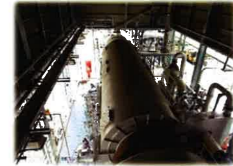
日本製紙石巻工場 CfFA 製造装置(外熱式キルン) 約850°Cで未燃カーボンを燃焼除去
