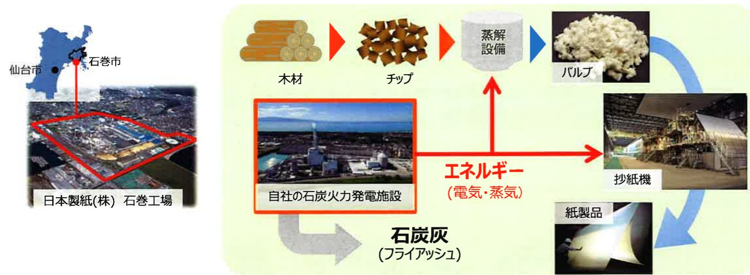
図1 紙の製造工程と石炭灰(フライアッシュ)の排出
